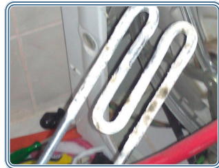
Kireçle kaplanmış ısıtıcı
