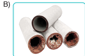
Tesisat borularında tortu oluşması
