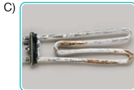
Çamaşır makinelerindeki rezistansın üzerinde tortu oluşması
